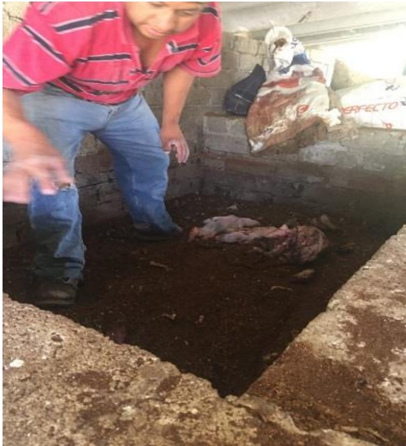
Figura 12. Reactor de compostaje de residuos de animales muertos y restos de placentas.
